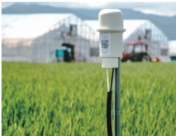
IIJの水田センサ。圃場の水位・水温データを収集し、自宅や作業場など離れたところから、スマホで水位・水温を監視することができます。
